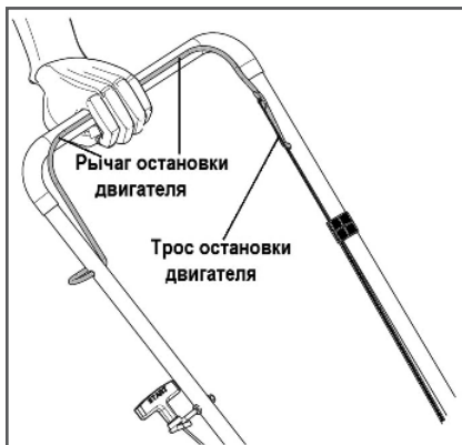
Рис. 7 Проверка работы троса остановки двигателя
