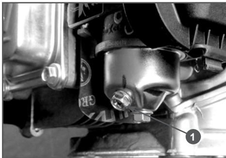
Рис. 11 Слив топлива из карбюратора
