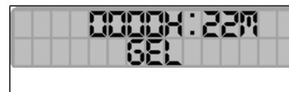
9. 3 значение (рабочее) - показывает в верхней строке отработанное время в текущей сессии. Нижняя строка показывает уровень заряда АКБ. По мере разрядки АКБ, последовательно гаснут полосы световой индикации в нижней строке. При полной разрядке АКБ гаснут все 10 полос и остается только мигающая индикация. Мигающий символ ":" показывает, что счетчик отсчитывает время текущей работы.
